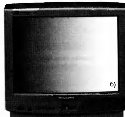
Рис. 7. Фрагмент измерительного сигнала IV, содержащий элемент G2 (а — форма сигнала; б — вид на экране телевизора)
